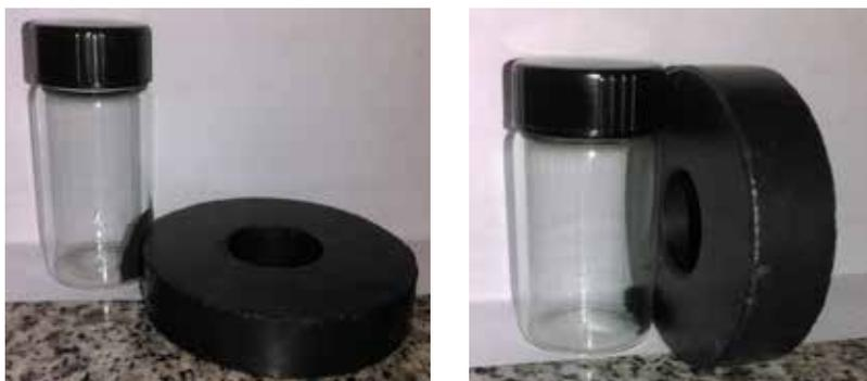
**Figura 1.** Magnetita sintetizada (izquierda), perlas de quitosano magnetizadas obtenidas (derecha).
