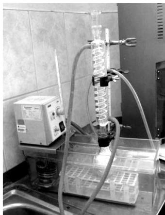
**Figura 1.** Proceso de saponificación de la muestra de aceite de sachá inchi para la determinación de fitoesteroles.
