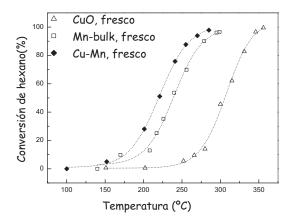
Figura 12. Comparación de la actividad del sistema equimolar Cu-Mn con la correspondiente a los óxidos simples CuO y MnO
