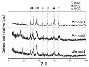
Figura 2. Difractogramas XRD de las muestras de óxido de Mn nanoparticulados preparados con diferentes concentraciones de sal precursora de acetato de Mn
