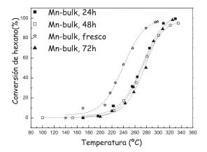
**Figura 11.** Curvas de ignición del óxido de Mn másico fresco y luego de 24, 48 y 72 h de contacto
