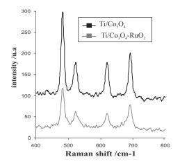
**Figura 9.** Análisis Raman de los electrodos Ti/Co<sub>3</sub>O<sub>4</sub>-RuO<sub>2</sub> y Ti/Co<sub>3</sub>O<sub>4</sub>
