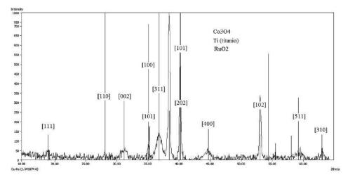
Figura 8. Análisis DRX del electrodo nanoestructurado de Ti/Co<sub>3</sub>O<sub>4</sub> -RuO<sub>5</sub>
