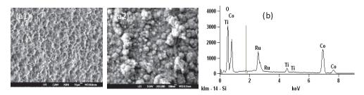
Figura 6. SEM del electrodo Ti/Co<sub>3</sub>O<sub>4</sub> (ED) a1) 300X; a2) 4000X; b) Análisis EDX
