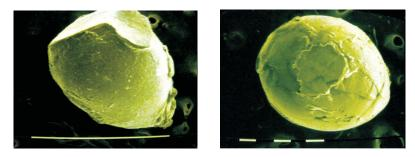
Figura 3. Fotografías de micropartículas secas de quitosano-TPP 1% en buffer 1,2 sin cargar (izq) y cargadas (der) con Cu<sub>2</sub>(μ-O<sub>2</sub>CCH<sub>3</sub>)<sub>4</sub>(METRO)<sub>2</sub> 2x10<sup>-3</sup>M
