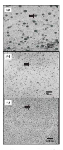
**Figura 4.** Micrografías TEM de la muestra Mn-nit2 no calcinada preparada con diferentes cantidades del agente peptizante y su correspondiente pH de la solución final a) pH=3,40 b) pH=3,08 c) pH=2,89
