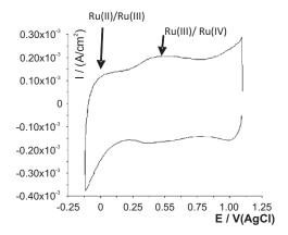
**Figura 3.** Voltagrama del electrodo Ti/RuO<sub>2</sub> nanoestructurado, H<sub>2</sub>SO<sub>4</sub> 0,1 M y 20 mV/s.
