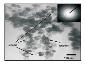
**Figura 5.** Micrografía TEM de la muestra Mn-nit2 preparada con agente peptizante a un pH=2,89 luego de la calcinación
