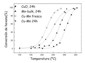
**Figura 13.** Comparación de las curvas de ignición del Cu- Mn (fresco y luego de 24 h) con las correspondientes a las muestras másicas de óxido de Cu y de Mn luego de 24 h
