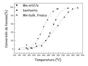
**Figura 14.** Comparación de las curvas de ignición de Mn-nit2/b, Mn-bulk con la correspondiente a la bentonita pura (sin componente activo)
