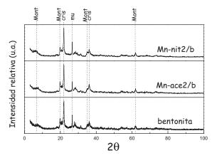
**Figura 3.** Difractogramas XRD de las muestras soportadas Mn-nit2/b, Mn-acet2/b y de la bentonita (sin componente activo)
