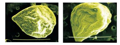
Figura 4. Fotografías de micropartículas secas de quitosano-TPP 5% en buffer 1,2 sin cargar (izq) y cargadas (der) con Cu<sub>2</sub>(μ-O<sub>2</sub>CCH<sub>3</sub>)<sub>4</sub>(METRO)<sub>2</sub> 2x10<sup>-3</sup>M
