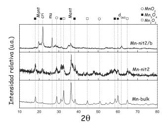
**Figura 1.** Difractogramas XRD de la muestra nanoparticulada Mn-nit2; másica Mn-bulk y soportada en bentonita Mn-nit2/b. Mont: montmorillonita, cri:cristobalita, mu: muscovita
