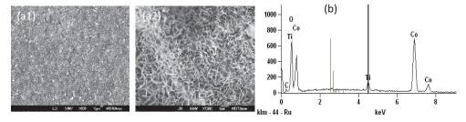
Figura 5. SEM del electrodo Ti/Co<sub>3</sub>O<sub>4</sub> (ED) a1) 300X; a2) 4000X;b) Análisis EDX
