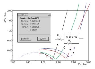
**Figura 10.** El diagrama Nyquis del electrodo Ti/Co<sub>3</sub>O<sub>4</sub> obtenido por electrodepósito en solución de NaOH 0,1 M a diferentes potenciales fijos 0,35 V (\*); 0,40 V (•); 0.45 (◊); 0,50 (▲)
