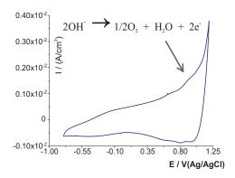
$\begin{array}{llll} \textbf{Figura 4.} & Voltagrama \ del \ electrodo \ de \\ Ti/Co_3O_4-RuO_2 & obtenido & mediante \\ electrodepósito (ED) de capas superpuestas \\ de los óxidos, Na_2SO_4 0,1 My \ 20 mV/s. \end{array}$
