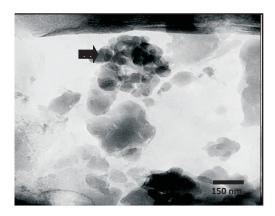
Figura 6. Micrografía TEM de la muestra Mn-nit2/b luego de la calcinación
