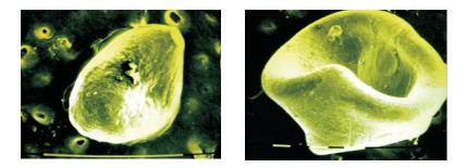
**Figura 5.** Fotografías de micropartículas secas de quitosano-TPP 10% en buffer 1,2 sin cargar (izq) y cargadas (der) con  $Cu_2(\mu-O_2CCH_3)_4(METRO)_2 2x10^3M$
