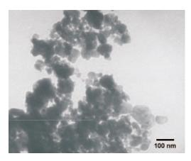
**Figura 9.** Micrografía TEM de la muestra Mn-ace3 luego de la calcinación con un tamaño promedio de partícula de 40 a 50 nm
