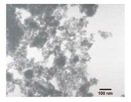
**Figura 8.** Micrografía TEM de la muestra Mn-ace2 luego de la calcinación con un tamaño promedio de partícula de 20 a 25 nm
