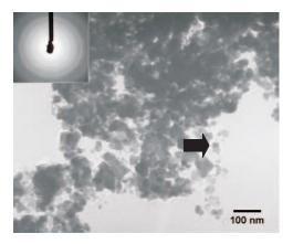
**Figura 7.** Micrografía TEM de la muestra Mn-ace1 luego de la calcinación con un tamaño promedio de partícula de 15 nm
