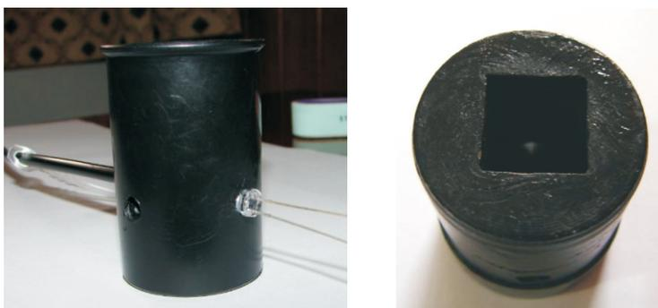
Figura 3. Ejemplos de dispositivos porta-celda.
