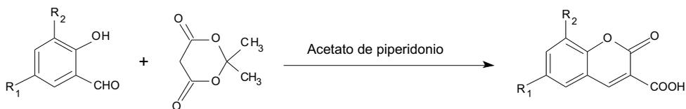
**Figura 2.** Esquema de síntesis para los ligandos cumarina-3-carboxilato y sus derivados
