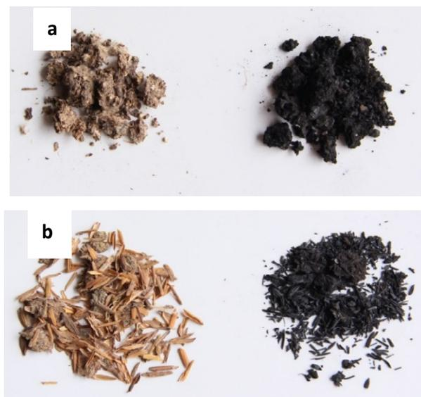
**Figura 2.** Muestras representativas de biomasa residual y respectivo biochar resultante.
