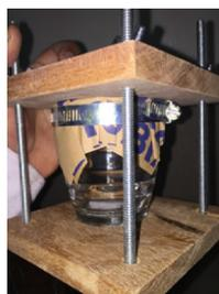
Figura 1. Dispositivo de fijación, simulante A y muestra de envase celulósico.
