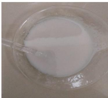
**Figura 2.** Nanocomposito de polisiloxano funcionalizado con NPs-Ag.
